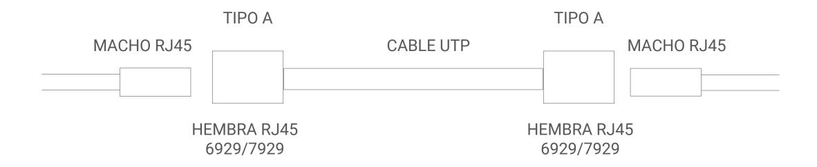
Si en uno de los extremos conecto según norma tipo B (ver diagrama), en el otro extremo debeo conetarlo según norma tipo B.
